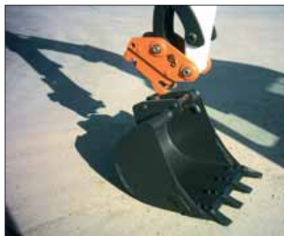
■ Il nuovo attacco rapido meccanico semiautomatico Eurobenne in sequenza di aggancio. Per mezzi dalle 5 t in poi è disponibile anche in versione idraulica Connection sequence for the new Eurobenne semi-automatic mechanical quick coupling. For 5-ton or larger vehicles the hydraulic version is also available
