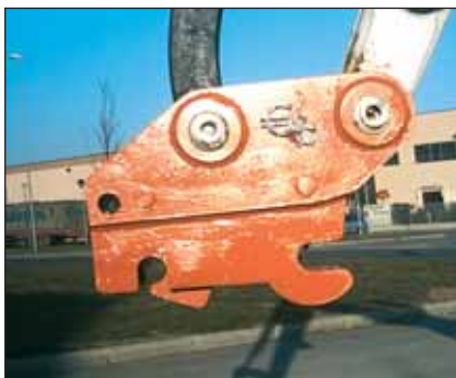
■ Il nuovo attacco rapido meccanico semiautomatico Eurobenne in sequenza di aggancio. Per mezzi dalle 5 t in poi è disponibile anche in versione idraulica Connection sequence for the new Eurobenne semi-automatic mechanical quick coupling. For 5-ton or larger vehicles the hydraulic version is also available
