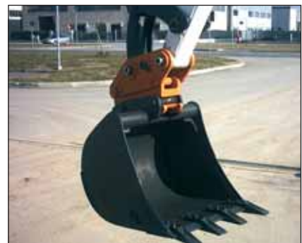
■ Il nuovo attacco rapido meccanico semiautomatico Eurobenne in sequenza di aggancio. Per mezzi dalle 5 t in poi è disponibile anche in versione idraulica Connection sequence for the new Eurobenne semi-automatic mechanical quick coupling. For 5-ton or larger vehicles the hydraulic version is also available
